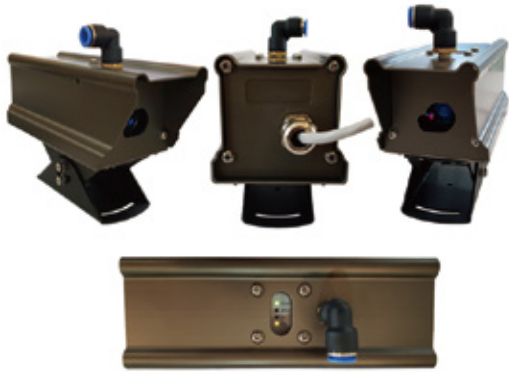
▶ Air Cooling Jacket - 시리얼 인터페이스 버전 분진이 많은 개소에서 레이저 센서의 렌즈 오염을 방지하고 고온의 환경에서 사용시 열손상을 방지하는 목적으로 Air Cooling Jacket 사용
